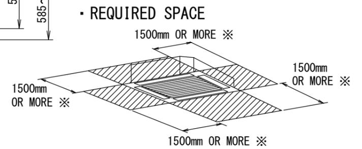
※ WHEN THE DISCHARGE GRILL IS CLOSEOUT, THE REQUIRED SPACE IS 200mm OR MORE.
