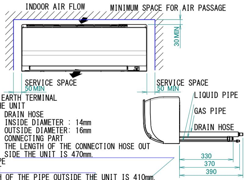
TERMINAL BLOCK WITH EARTH TERMINAL LOCATED INSIDE OF THE UNIT
