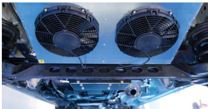
Instalace kondenzátoru SFZ 009e v zadní části vozidla.
