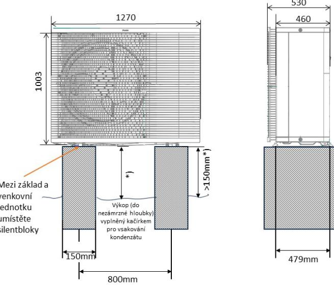
\*) Venkovní jednotku je třeba instalovat tak, aby byl otvor pro odtok kondenzátu neblokován a byl pod ním volný prostor alespoň 150mm. Výška základu minimálně 150mm (včetně silentbloku).
