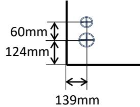
Umístění připojovacích otvorů chladivového potrubí na venkovní jednotce
