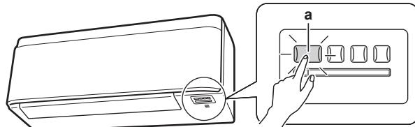
**a** Spínač a provozní kontrolka vnitřní jednotky ON/OFF
